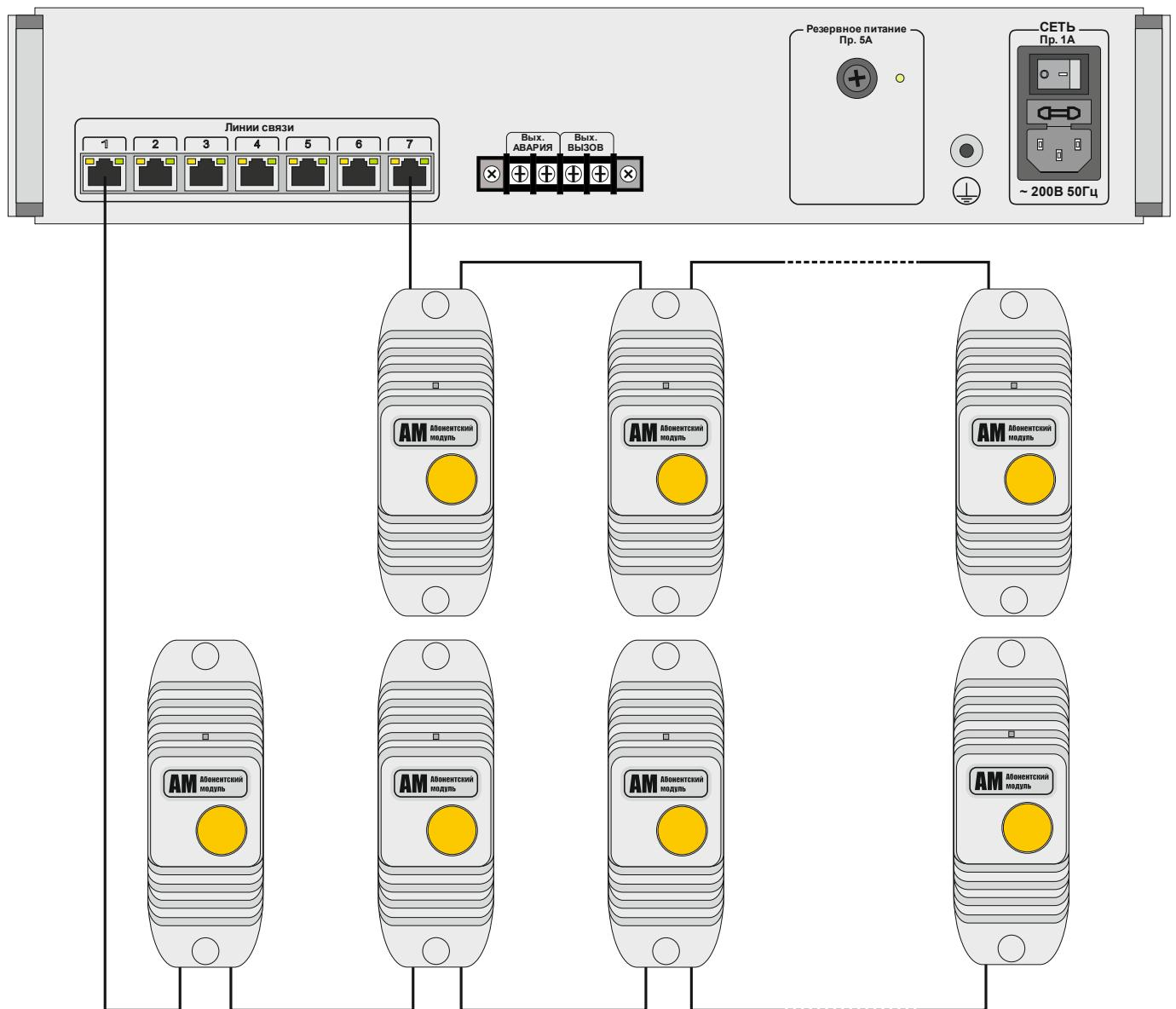
Рис. 1 Вариант подключения абонентских модулей к устройству
