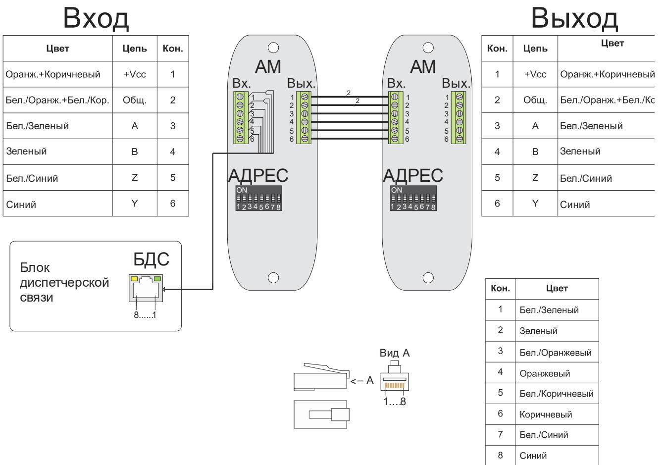
**Рис. 2 Подключение абонентских модулей к линиям связи**
