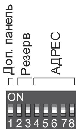
**Рис. 4 Переключатель адреса модуля**
