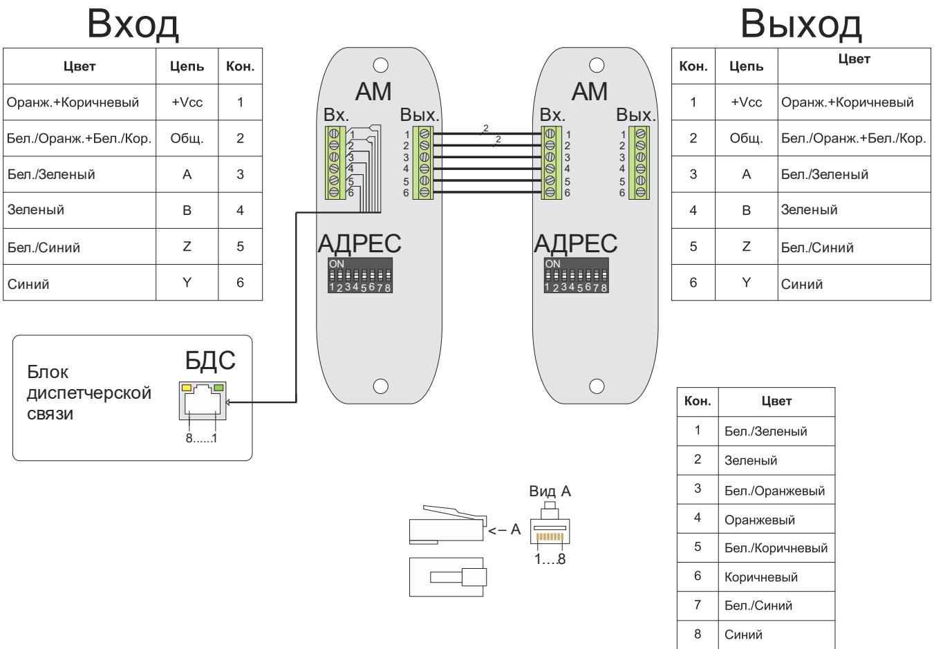
Рис. 2) должна прокладываться в виде витой пары проводов!
