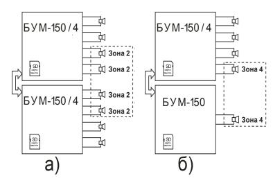
Рис. 1.11 Варианты составных зон оповещения где синхронное звучание не гарантировано
