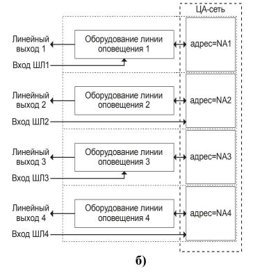
Рис. 1.6 Информационные модели блоков БУМ-150 с одним (а), и БУМ-150/4 с двумя (б) системными входами. Адреса NA1...NA4 выбираются из диапазона 1...63
