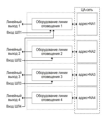
Рис. 1.8 Информационная модель блока БУМ-150/4 при переназначении внутренних входов
