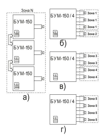
Рис. 1.10 Варианты составных зон оповещения с синхронным звучанием
