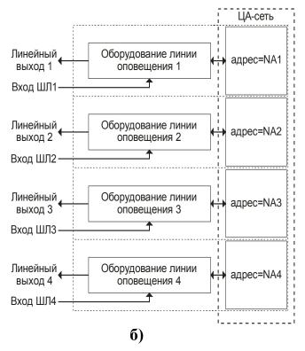
Рис. 1.5 Информационные модели блоков БУМ-100, БУМ-150 (а) и БУМ-150/4 (б). Назначение всех входов — по умолчанию. Адреса NA1...NA4 выбираются из диапазона 1...63
