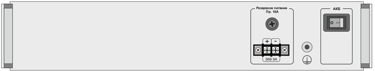
Рис. 3. Задняя панель блоков БРП-36/07, БРП-36/14.
