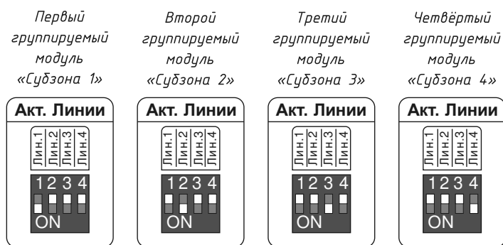
Рис. 2.5 Установка переключателей "Акт. Линии" при объединении блоков БУМ
