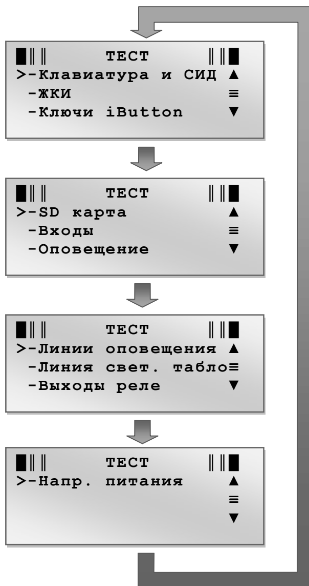
Рис. 2.35 Вид подменю ТЕСТ СИСТЕМЫ
