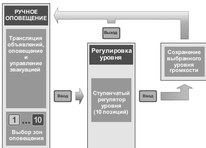
Рис. 2.9 Действия при регулировке уровня микрофонной гарнитуры
